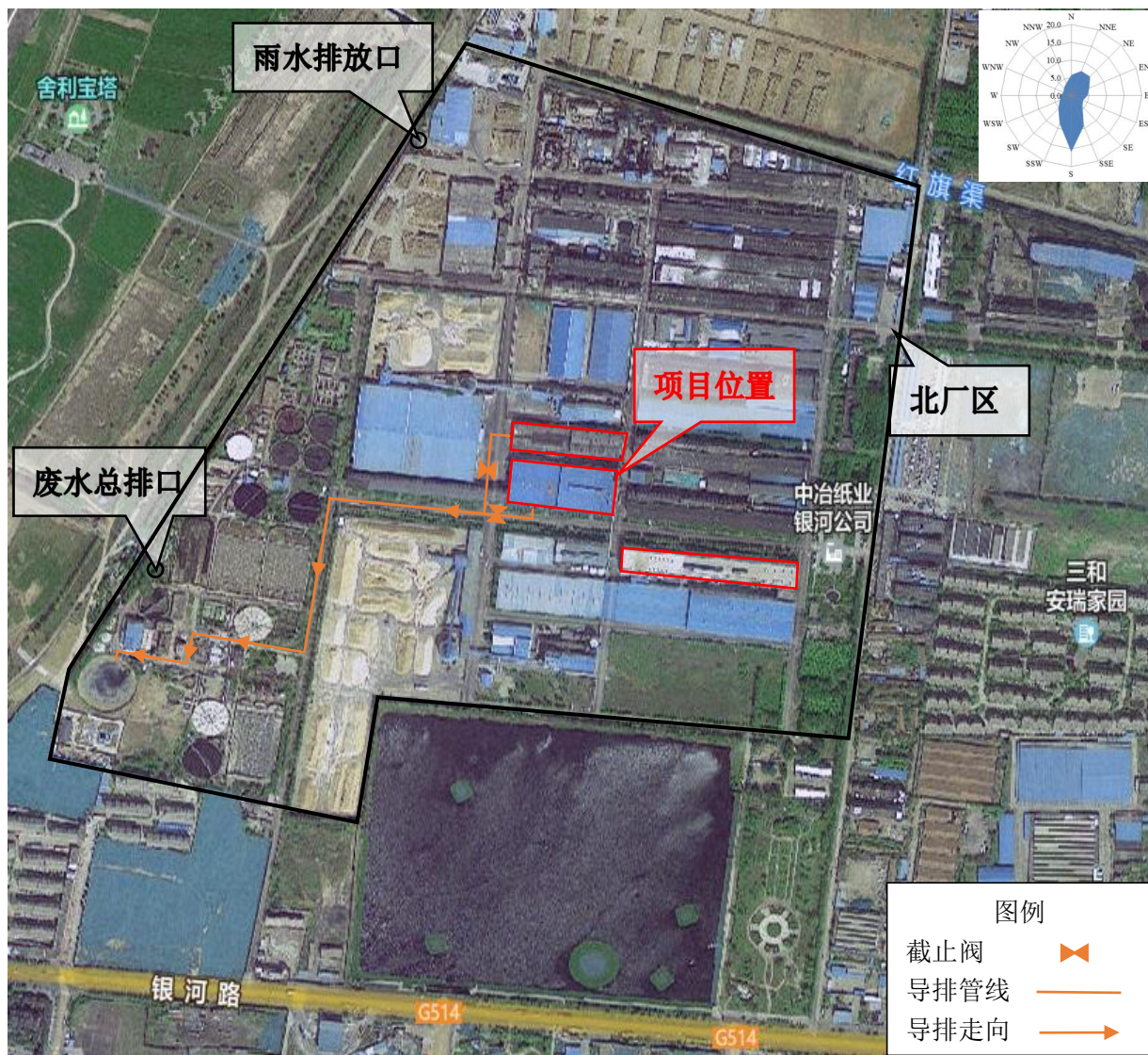
图 7.7-2 (a) 项目事故废水导排系统图
