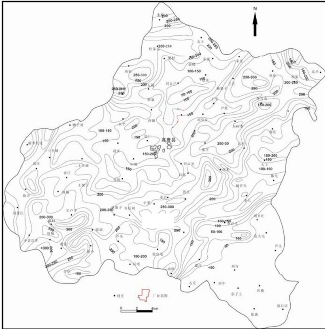
图 3.1.3-4 高唐县深层地下水淡水顶板埋深等值线图 (m)
