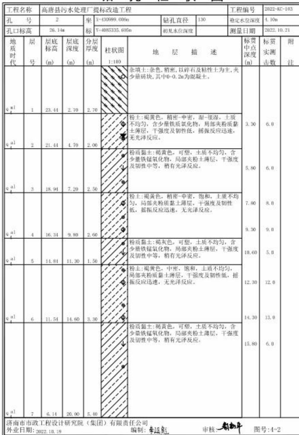
图 4.4.4-2 场址区域钻孔柱状图
