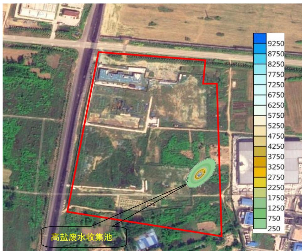
图 6.4-1 (4) 跑冒滴漏情况下氯化物污染范围图 (1000d)
