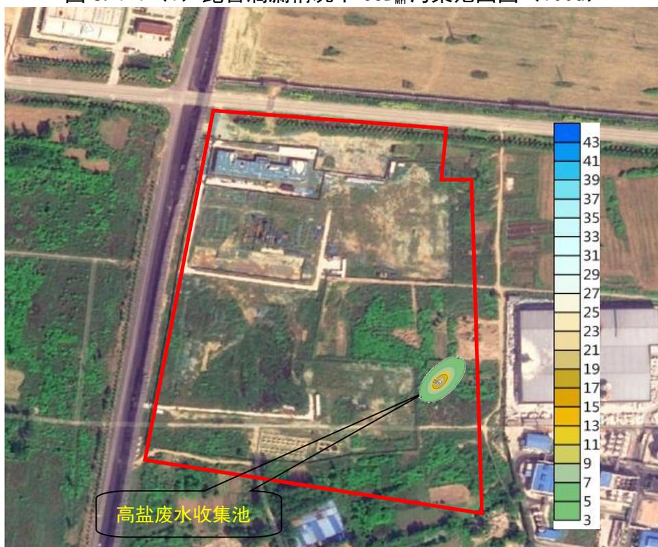
图 6.4-1 (2) 跑冒滴漏情况下  $\text{COD}_{\text{Mn}}$  污染范围图 (1000d)
