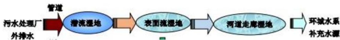
图 5.4-2 森泉人工湿地污水处理工艺流程图
