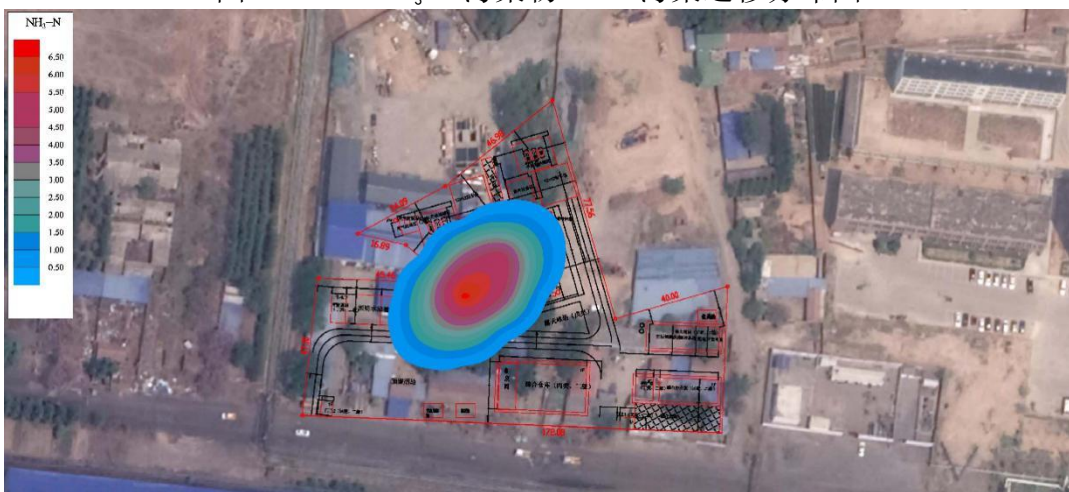
图 5.4-17 \text{NH}_3\text{-N} 污染物 1000d 污染运移分布图
