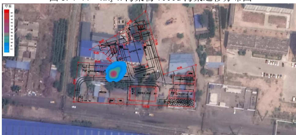
图 5.4-12 甲苯污染物 100d 污染运移分布图
