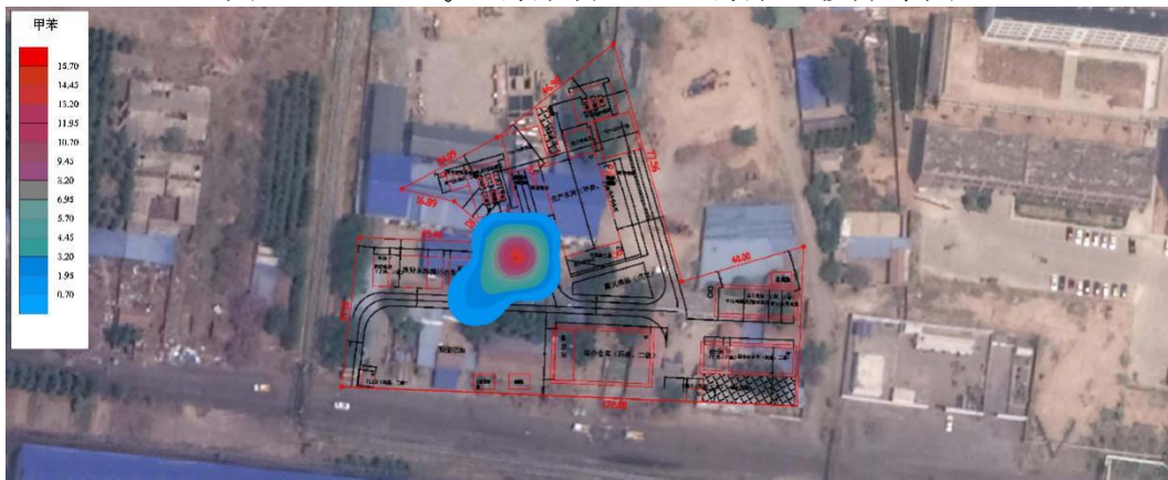
图 5.4-18 甲苯污染物 100d 污染运移分布图
