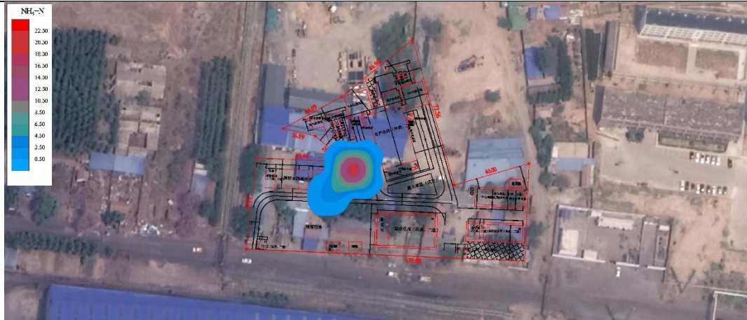
图 5.4-16 \text{NH}_3\text{-N} 污染物 100d 污染运移分布图
