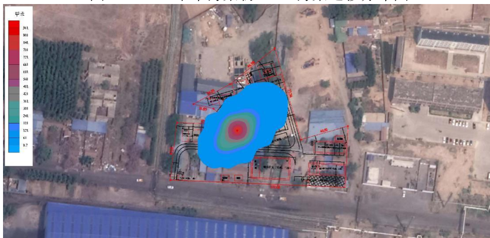
图 5.4-13 甲苯污染物 1000d 污染运移分布图
